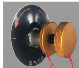
注意：在不影响裁切性能的情况下，尽量减少压纸压力，有利于机器使用寿命与安全。
