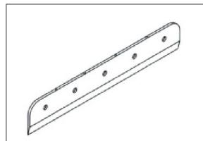
取出一片新刀片，注意安全，刀锋朝外，将两根拆刀螺杆拧在刀片开口孔内，再把刀片装在刀架上，依次用螺丝拧紧固定，然后根据切入深度调节方法进行调节。
