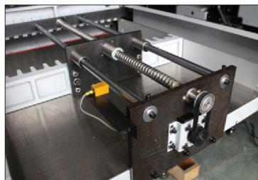
调整丝母上的限位支片，可前后调节移动，直至显示屏显示尺寸与标尺尺寸相符，然后锁紧固定螺丝；
